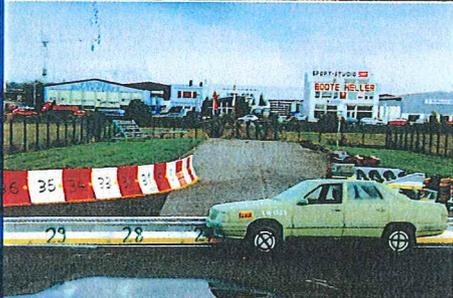
Die anprallenden Fahrzeuge werden durch **MINIGUARD** sanft umgelenkt, in die korrekte Fahrtrichtung geführt und kontrolliert verzögert. Die unmittelbar auf die Insassen einwirkenden Verzögerungs- und Beschleunigungswerte sind überaus gering.
